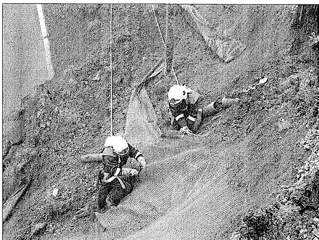
Abbildung 13 Entnahme von Probestücken des Geogitters Fortrac® 1200/50-10 A
