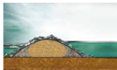
Buhnen und Wellenbrecher
