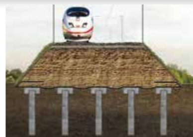
Bewehrung über vertikalen Traggliedern
