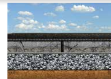
Sanierung von Betonflächen mit Asphalt
