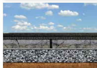
Sanierung von Betonflächen mit Asphalt
