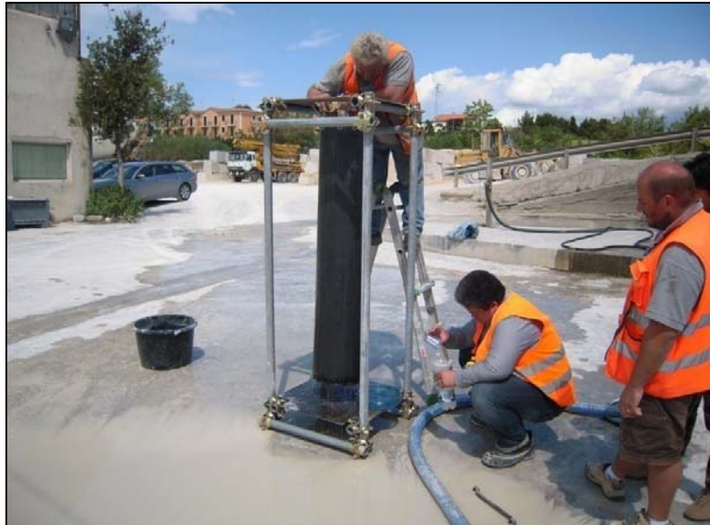
Abbildung 5: „Hanging-Bag-Test“ nach Koerner [9]
