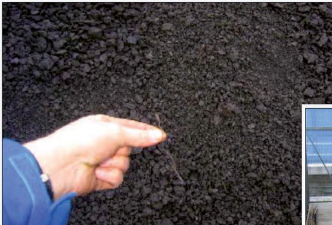
Figura 3 - Nel fresato sono state rinvenute solo fibre di lunghezza esigua
