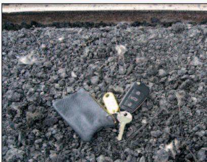
Figura 7 - All'interno del fresato, sono presenti solo poche e corte fibre
